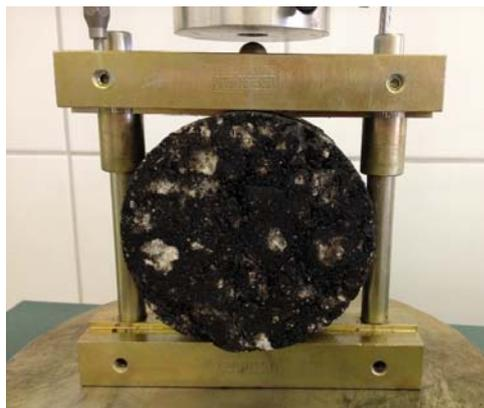
Figura 3.22: Molde preparado para RT, com termômetro para calibração
