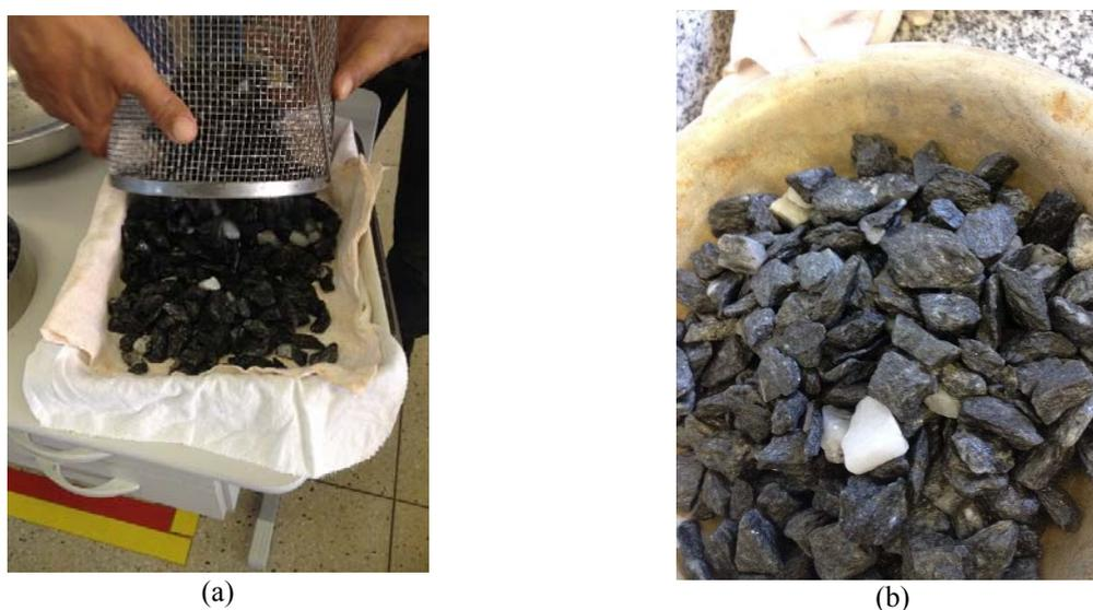
Figura 3.6: Balança hidrostática para obtenção da massa imersa em água
