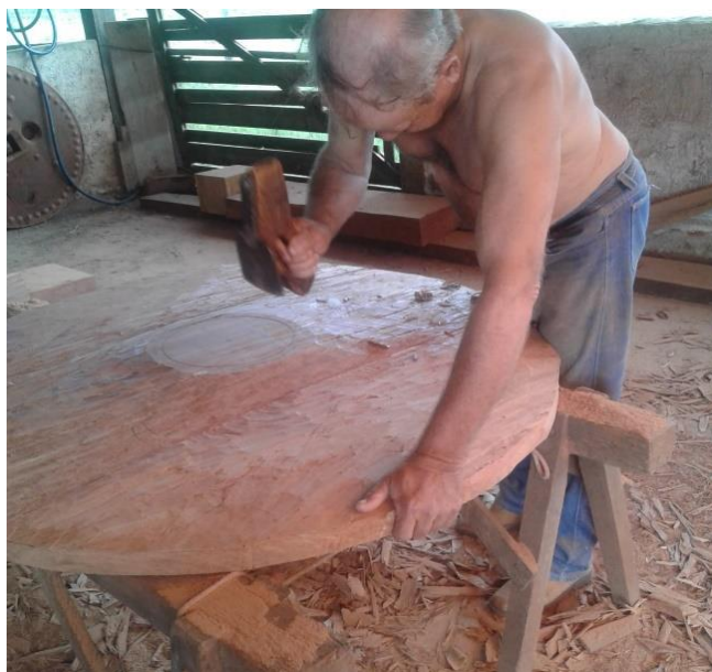
FOTOGRAFIA 25 - O carapina modelando a roda com sua enxó companheira
