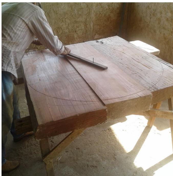
FOTOGRAFIA 22 - Risco do tamanho final da roda a partir da medição do ponto central
