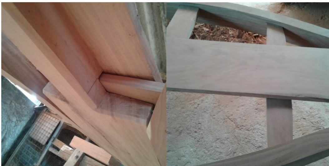
FOTOGRAFIA 43 - Detalhe da parte de baixo da mesa e a precisão dos encaixes entre as arreias que unem chêdas e cabeçalho
