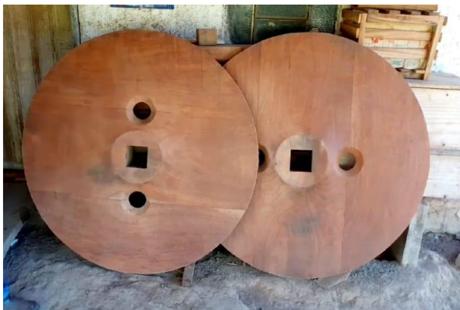
FOTOGRAFIA 27 - O modo pelo qual devem ser encaixadas as rodas no carro
