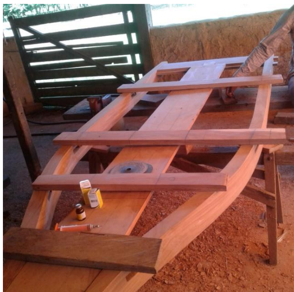
FOTOGRAFIA 41 - Arreias sobrepostas na mesa, prontas para serem encaixadas
