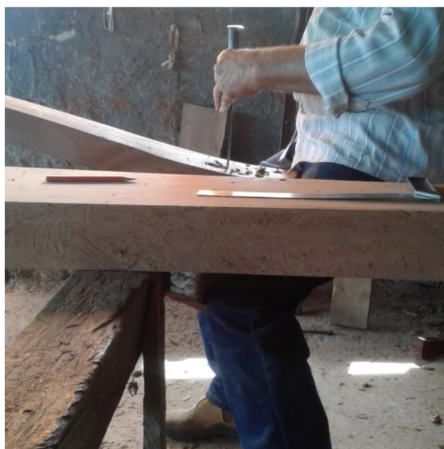
FOTOGRAFIA 40 - O carapina fura nas chêdas os locais pelos quais passarão as arreias que interligam as peças laterais ao cabeçalho
