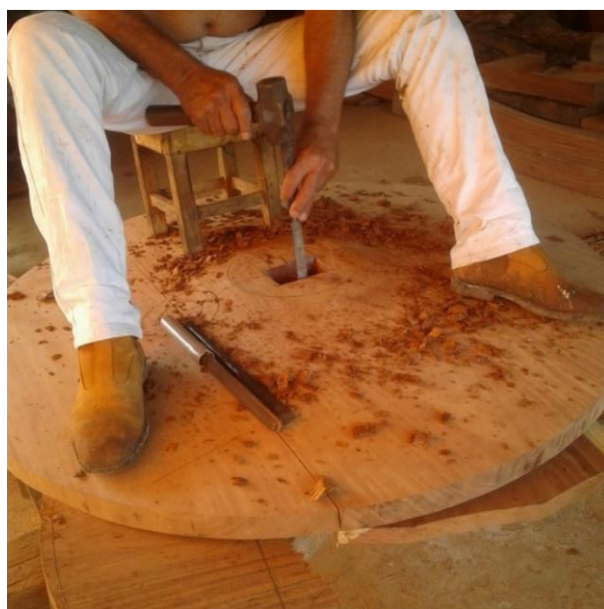
FOTOGRAFIA 26 - O carapina cava manualmente a bomba (espiga)
