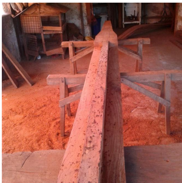
FOTOGRAFIA 31 - O cabeçalho devidamente recortado em suas laterais
