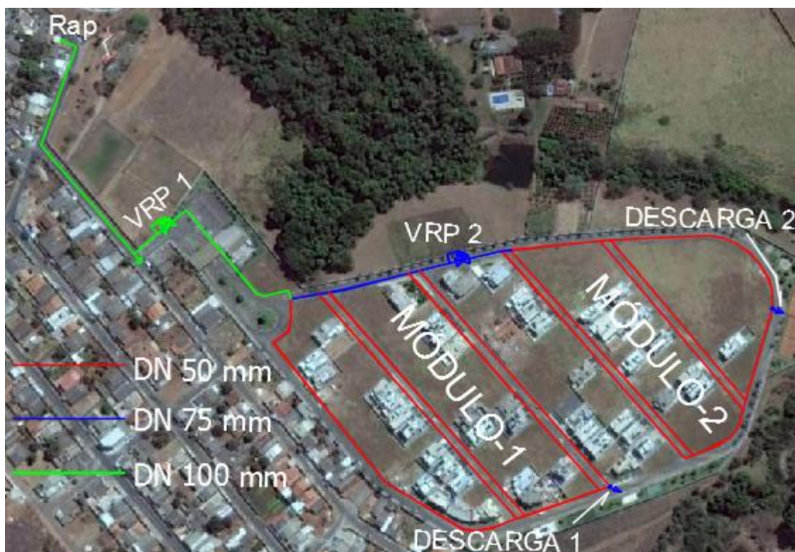
Figura 07 – Área do condomínio Vale dos Pássaros e localização do reservatório apoiado (Rap) e rede de distribuição
