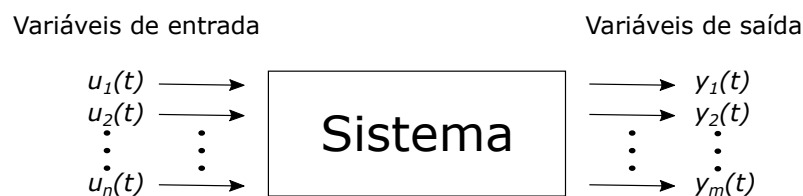
Figura 59 – Diagramas de blocos de um sistema que se baseia em equações de espaço de estados
