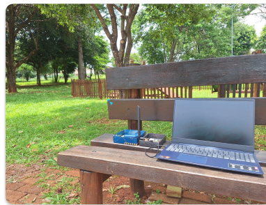
b) Aparato de Testes: Computador para Emular o LIDAR e Rádio RA-08H
