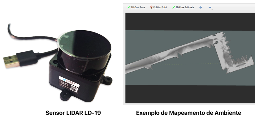
Figura 2.7: Sensor LIDAR LD19 e Exemplo de Aplicação do LIDAR com Mapeamento de Ambiente - Autoria Própria
