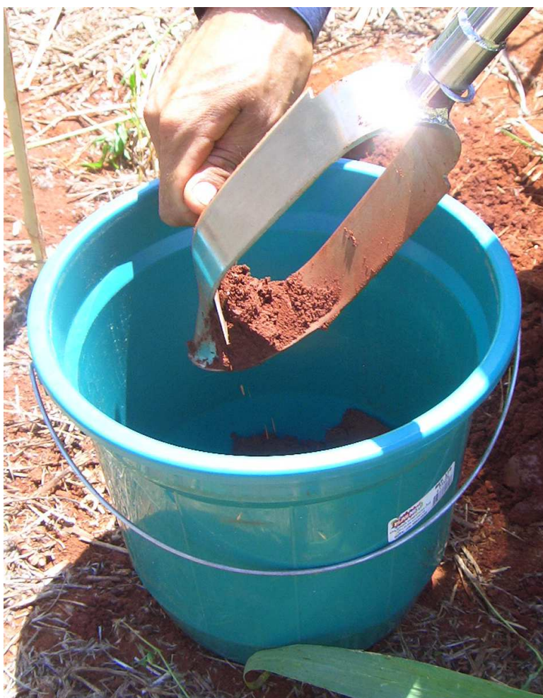
Figura 13. Coleta de terra usando o trado holandês grande (TGR).
