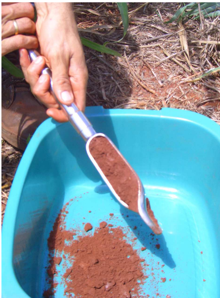
Figura 14. Coleta de terra usando o trado holandês pequeno (TPE).
