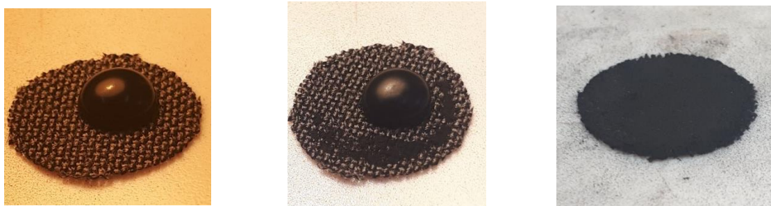
Figura 46 – Ilustração do preparo das camadas catalíticas e difusora mediante pintura com tinta catalítica.
