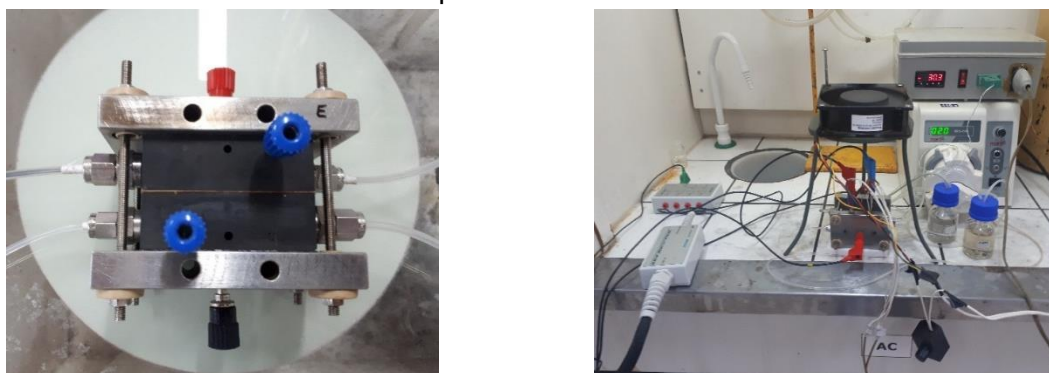
Figura 45 - Visão da célula unitária e do sistema durante realização dos ensaios de performance.
