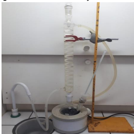
Figura 16 - Aparato empregado na funcionalização dos diferentes suportes catalíticos.
