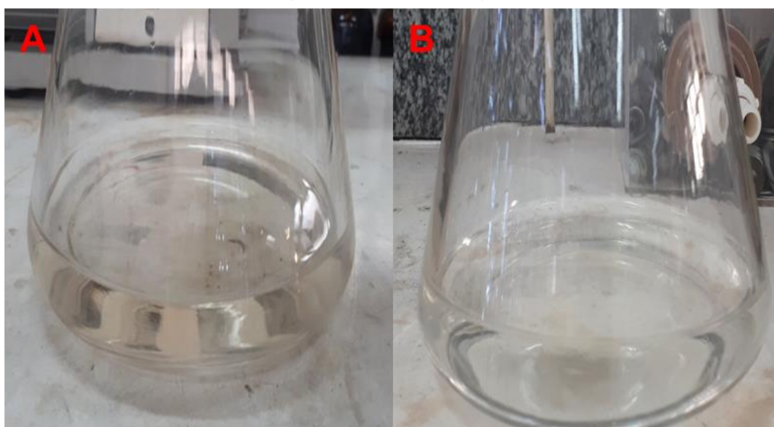
Figura 34 - Nanopartículas de Pd presentes no filtrado sem funcionalização do suporte (A). Ausência de evidência de nanopartículas de Pd presentes no filtrado com o emprego de suporte funcionalizado (B).
