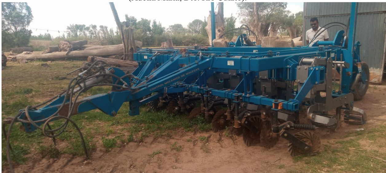
Figura 24 - Maquinaria adaptada para control mecánico de especies espontaneas en maíz orgánico (Adelia María, Dto. Rio Cuarto).
