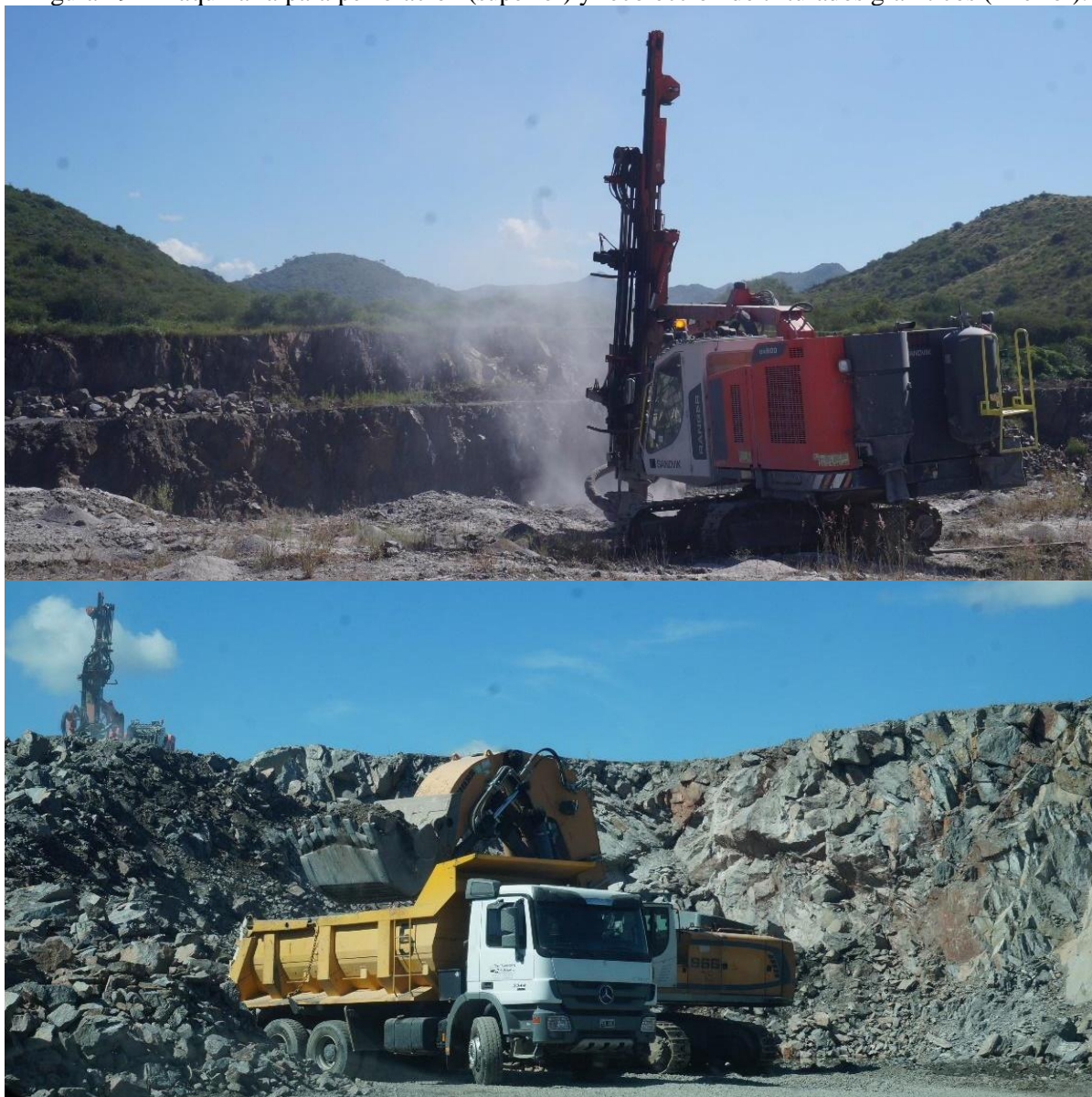
Figura 29 - Maquinaria para perforación (superior) y recolección de triturados graníticos (inferior).
