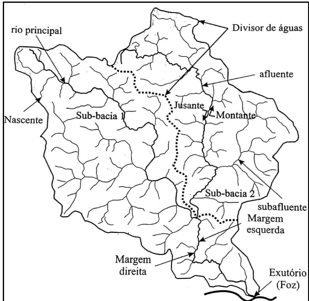
Figura 06 - Elementos que compõem uma bacia hidrográfica.
