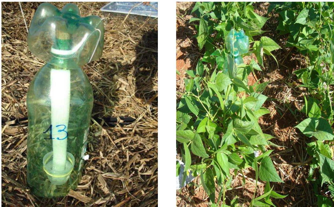
Figura 3.3. Câmara coletora de N amoniacal ( \text{N-NH}_3 ) volatilizado do solo após adubação nitrogenada em cobertura no feijoeiro. Santo Antônio de Goiás, GO, 2009
