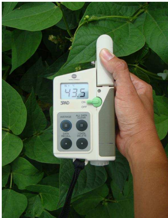
Figura 3.4. Leitura do índice relativo de clorofila na folha do feijoeiro com o aparelho Minolta SPAD-502®. Santo Antônio de Goiás, GO, 2009
