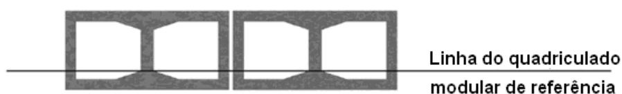
Ilustração 2.24 – Componentes em posição assimétrica em relação à linha do reticulado modular de referência.
