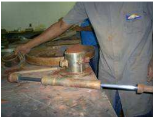
Ilustração 3.3 – Equipamentos usados no ensaio de compactação.
