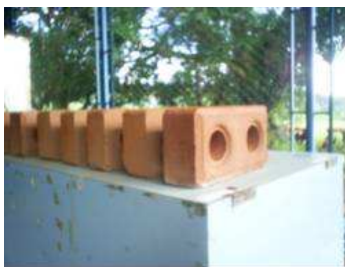
Ilustração 2.22- Tijolos modulares (dimensões 25,0 x 12,5 x 6,25 cm).
