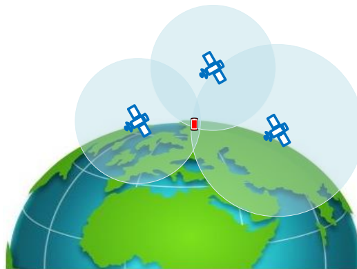
Figura 2.19 – GPS – Trilateração com ToA.
