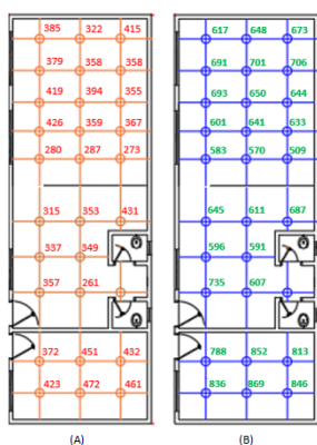
Fig. 15. Iluminância em Lux para lâmpadas tubulares fluorescentes (A) e lâmpadas tubulares de LED (B).
