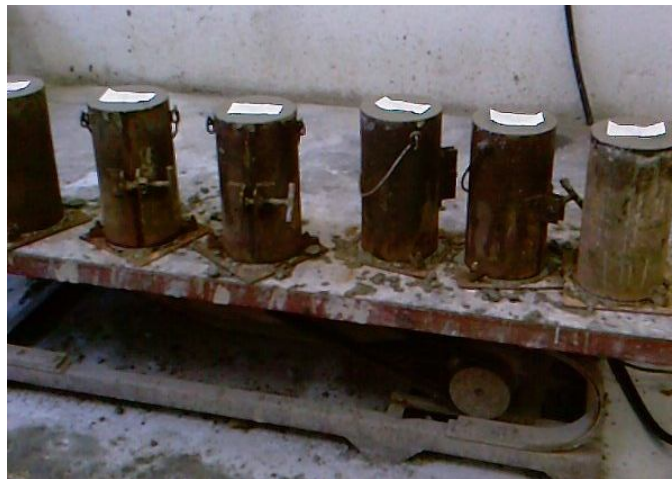
Fotografia 4.4 – Moldagem dos corpos-de-prova 150 x 300 mm.
