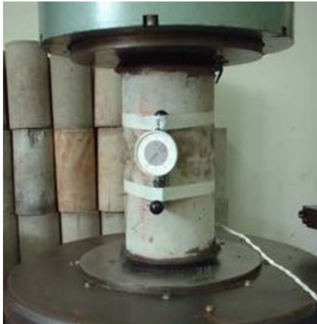
Fotografia 2.1 – Ensaio de determinação do módulo de deformação estático com comparador mecânico de base móvel em corpo-de-prova 15x30cm
