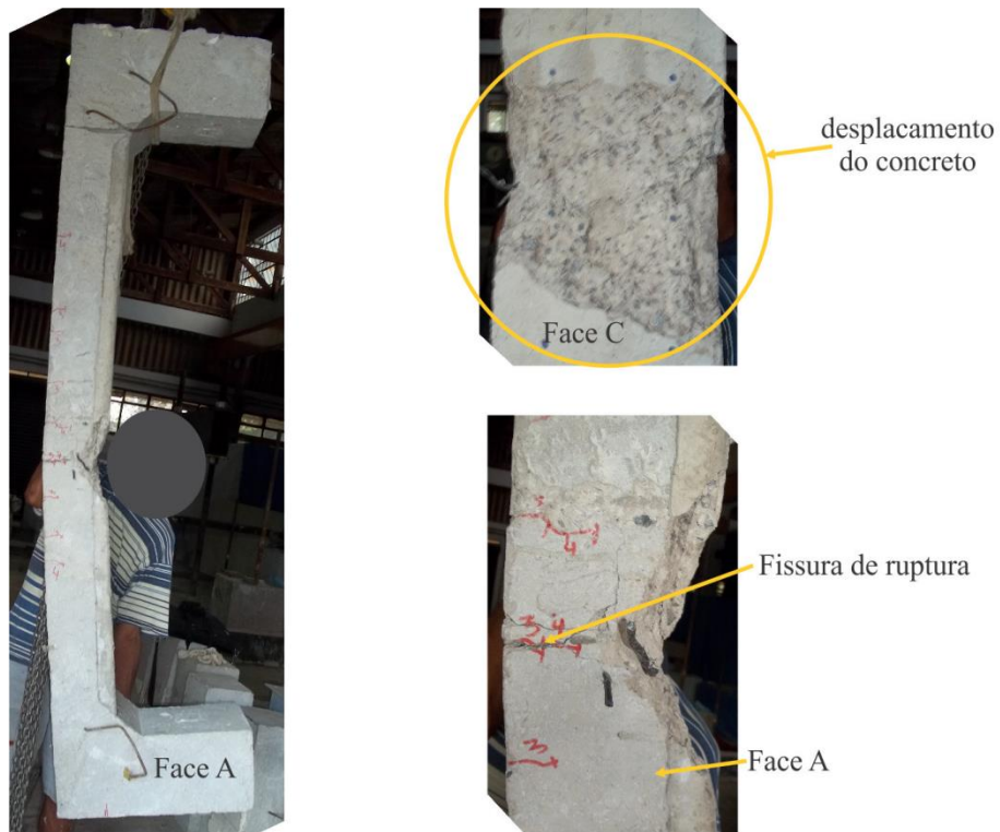
Figura 4. 15 - Região de ruptura do pilar PAF-150-18
