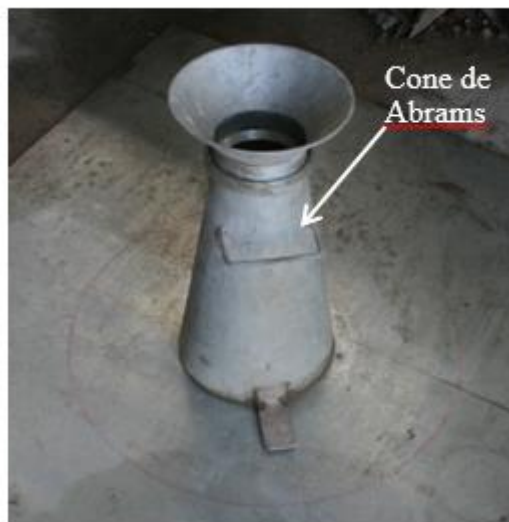
Figura 2. 21 - Ensaio slump flow
