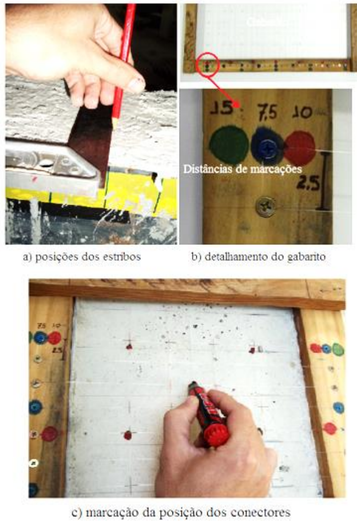
Figura 3. 21 - Marcação da posição dos estribos e dos parafusos chumbadores
