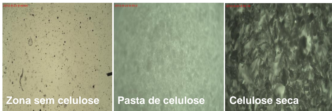
Figura 19. Micrografias ópticas mostrando as superfícies antes a após a adição de celulose.
