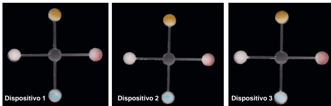
Figura 23. Imagens obtidas para comparação entre dispositivos utilizando mistura padrão de glicose, colesterol e proteínas totais.
