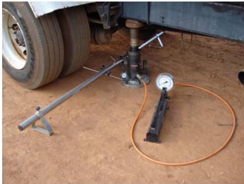
Figura 2.15 - Equipamentos utilizados no ensaio de prova de carga sobre placa.
