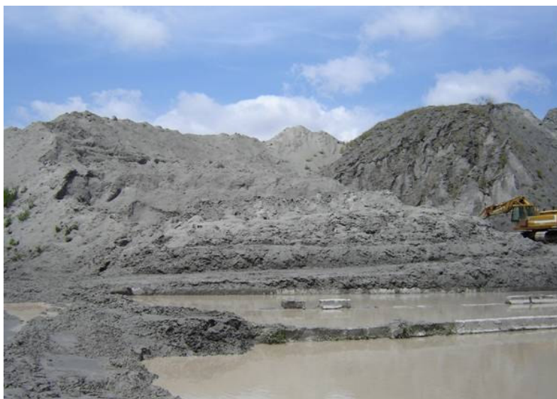
Figura 2.5 – Pilhas de pó de micaxisto gerada no processo de lavagem da brita
