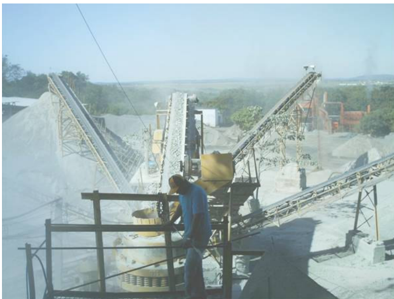
Figura 2.3 – Vista superior do processo de trituração da rocha micaxisto na pedreira do DERMU-COMPAV de Goiânia.
