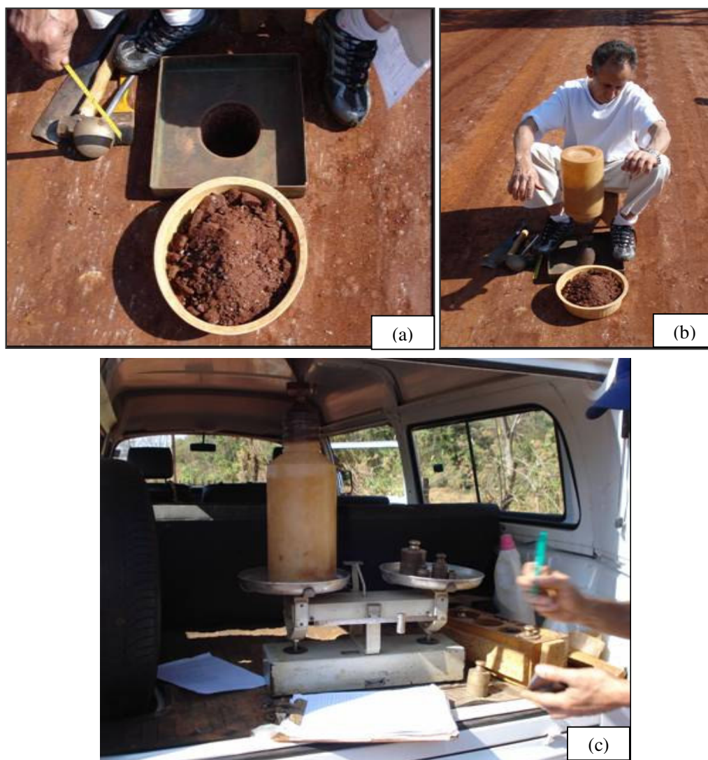
Figura 3.24 - Ensaio da densidade pelo método do frasco de areia: abertura do orifício na camada (a); preenchimento com areia do frasco (b) e pesagem do frasco (c).
