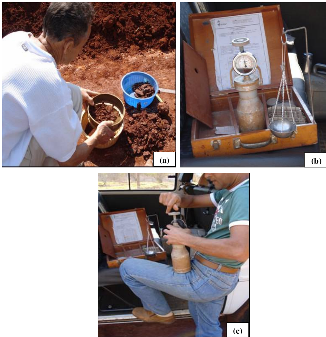
Figura 2.12 – Ensaio método Speedy : (a) Preparo da amostra de solo no ponto de execução do frasco de areia; (b) Aparelhagem utilizada no ensaio; (c) Detalhe do início do ensaio, com a amostra de solo e a ampola de carbureto de cálcio no aparelho.
