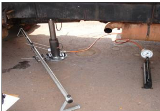
Figura 3.26 – Disposição dos equipamentos para ensaio de Prova de Carga Sobre a Placa.
