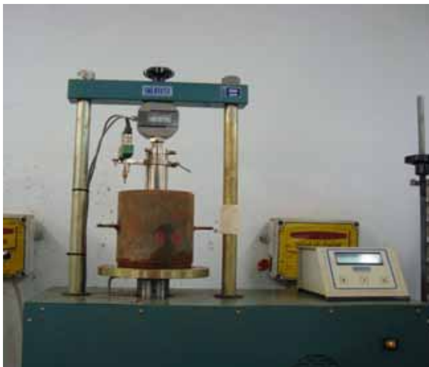
Figura 5.12 – Prensa utilizada no ensaio de CBR
