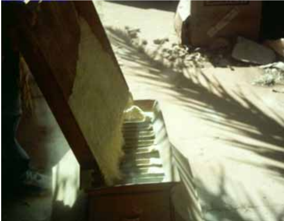
Figura 5.2 – Quarteamento do fosfogesso
