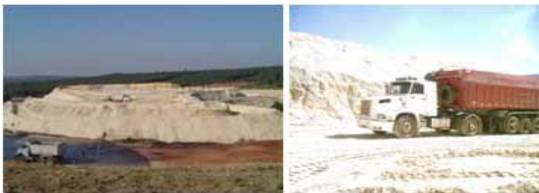
Figura 2.9 – Armazenamento do fosfogesso em pilhas
