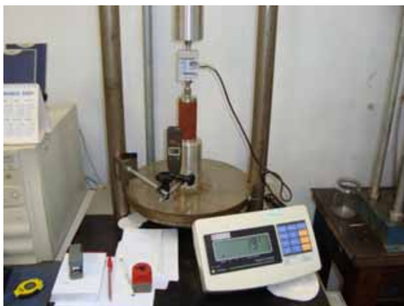
Figura 5.14 – Ensaio de resistência a compressão simples em andamento
