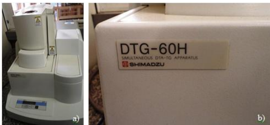
Figura 4.22- Termobalança utilizada nas análises termogravimétricas.
