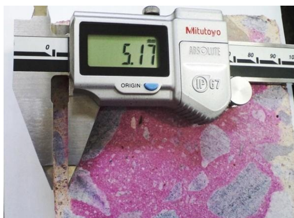
Figura 4.19- Medida da profundidade carbonatada por meio de paquímetro digital.
