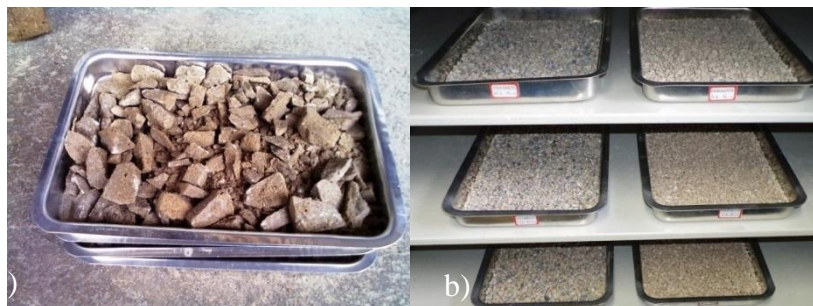
Figura 4.12- Material utilizado no processo de dessorção do condicionamento, onde se vê em a) material obtido após passagem pelo britador, e em b) material após a trituração no quebra gelo.
