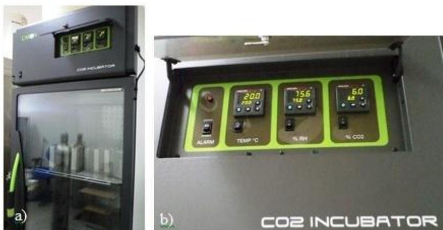
Figura 4.15- Detalhes: a) Incubadora de CO 2 e b) Painel de controle.
