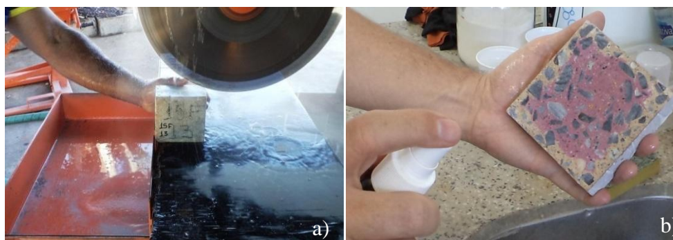
Figura 4.16- a) Corte das amostras com cortadeira elétrica e b) momento da aspersão da fenolftaleína.
