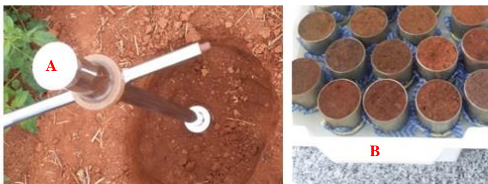
Figura 5. Coleta de amostragem de solo com o coletor amostrador de solo (A); Processo de saturação das amostras indeformadas (B).
