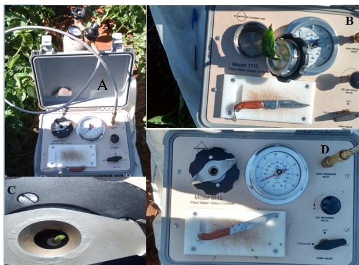
Figura 6. Avaliação do potencial de água na folha: Câmara de Scholander (A), folha seccionada colocada na câmara (B), pecíolo voltado para fora da câmara, através de uma borracha usada para vedar a câmara de pressão (C), leitura do surgimento da seiva (D).
