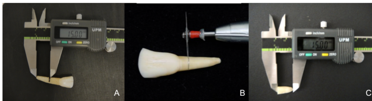
Figura 3 – Secção coroa-raiz. (A) Mensuração de 15mm de extensão cérvico-apical do dente bovino. (B) Secção da raiz com disco diamantado. (C) Confirmação da extensão cérvico-apical com paquímetro digital (Fonte: Autor).
