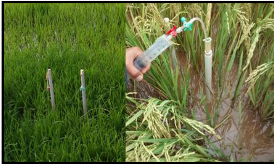
Figura 2.4. Extratores de solução do solo, instaladas na área experimental da Fazenda Palmital, Goianira-GO.
