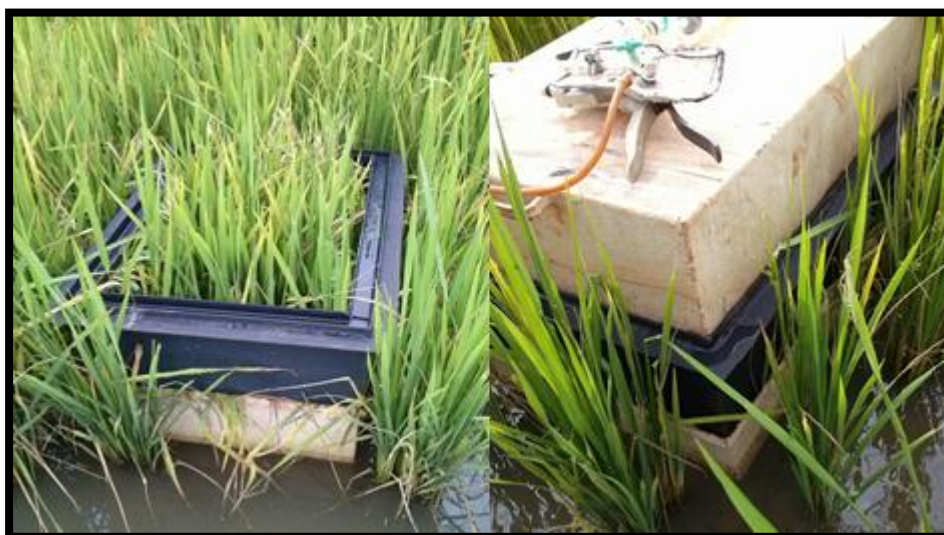
Figura 2.2. Câmaras de coleta de N 2 O retangular (Mosier, 1989), instaladas na área experimental da Fazenda Palmital, Goianira-GO.
