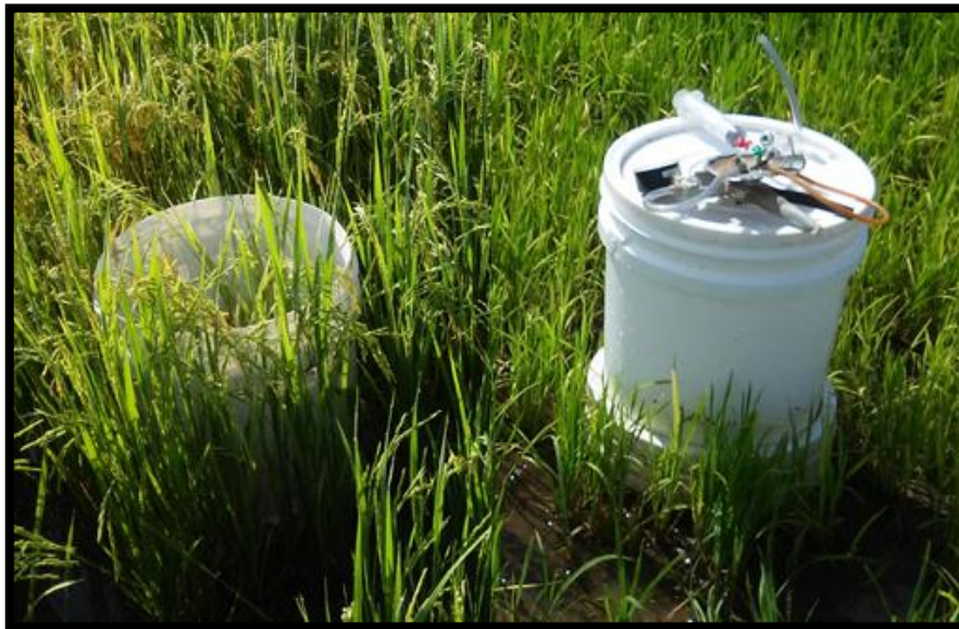
Figura 2.3. Câmaras de coleta de N_2O confeccionadas com baldes plásticos branco de 30 litros (Mosier, 1989), instaladas na área experimental da Fazenda Palmital, Goianira-GO.
