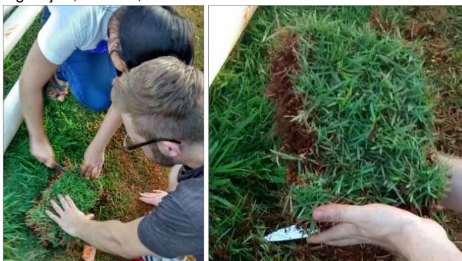
Figura 17. Coleta de material para realização de experimento didático representativo de processos erosivos em solos com vegetação, Goiânia, 2015.
