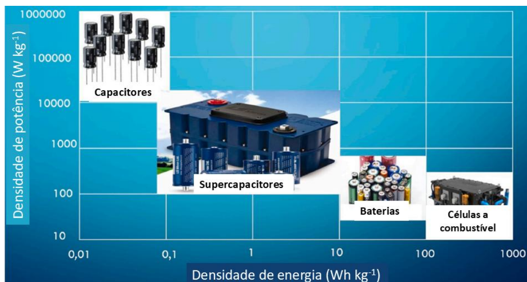
Figura 1.1: Diagrama de Ragone de dispositivos convencionais de armazenamento de energia. Adaptado de How et al. A review on the binder-free electrode fabrication for electrochemical energy storage devices. Journal of Energy Storage, 51 (2022) 104324, Copyright 2025, permitido por Elsevier [40].
