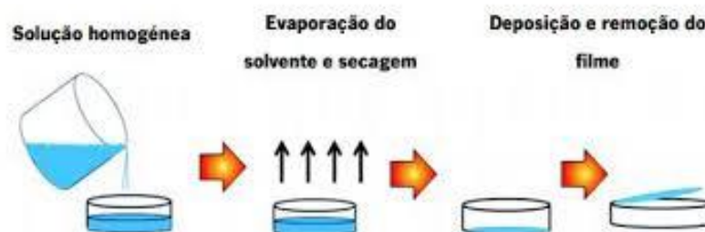
Figura 16: Esquema de deposição pela técnica de casting .
