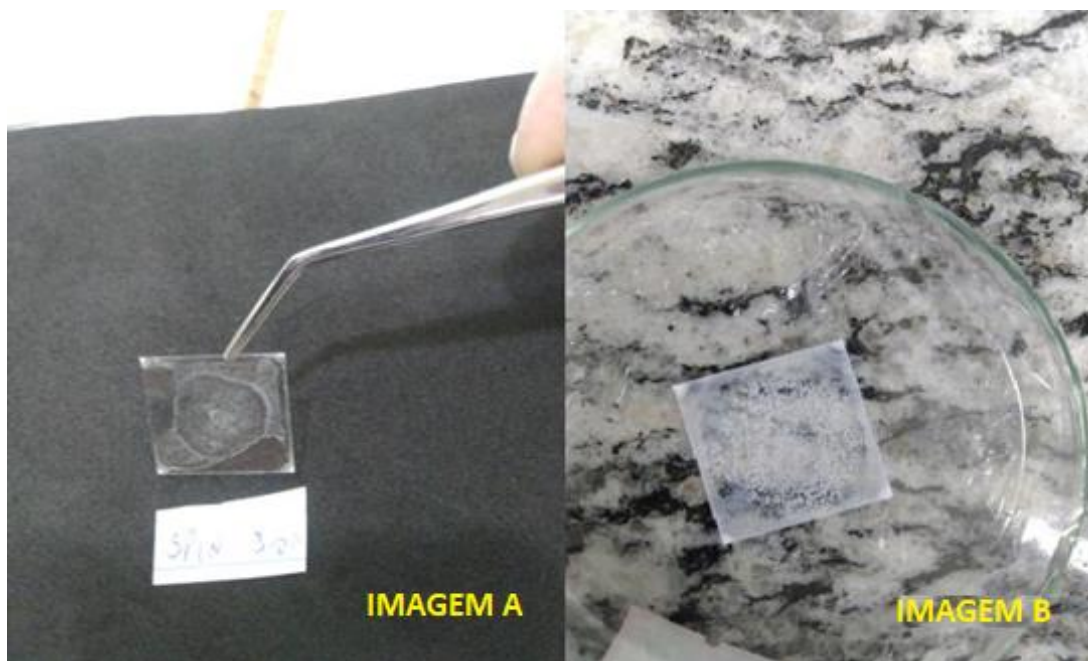
Figura 11: Filme depositado por spin-coating . a) Filme com AMPYZCAD E PS. b) Filme com AMPYZCAD E PMMA.
