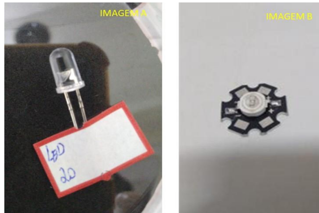
Figura 19: LED's comerciais do tipo estrela que foram usados para a deposição. a) LED convencional, tipo DIP. b) LED tipo estrela.
