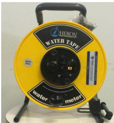
Figura 06 – Instrumento de medição de nível. Fonte: Autoria Própria. Instrumento disponível no Lab. de Hidráulica da UFG-Campus I (13/04/2016).
