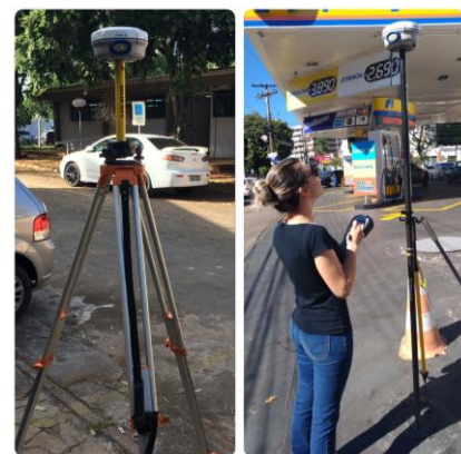
Figura 07 – GPS RTK Trimble R6. Fonte: Autoria Própria. Instrumento disponível no Lab. de Hidráulica da UFG-Campus I (24//07/2017).
