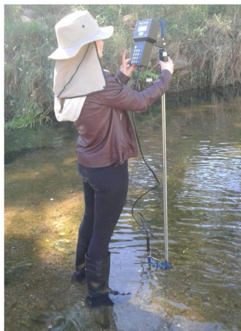
Figura 11 – Medição de vazão. Fonte: A própria autora.
