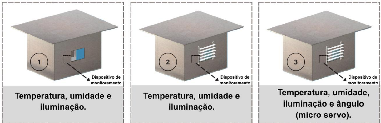
Figura 18 – Indicação da posição e dos dados coletados em cada dispositivo.
