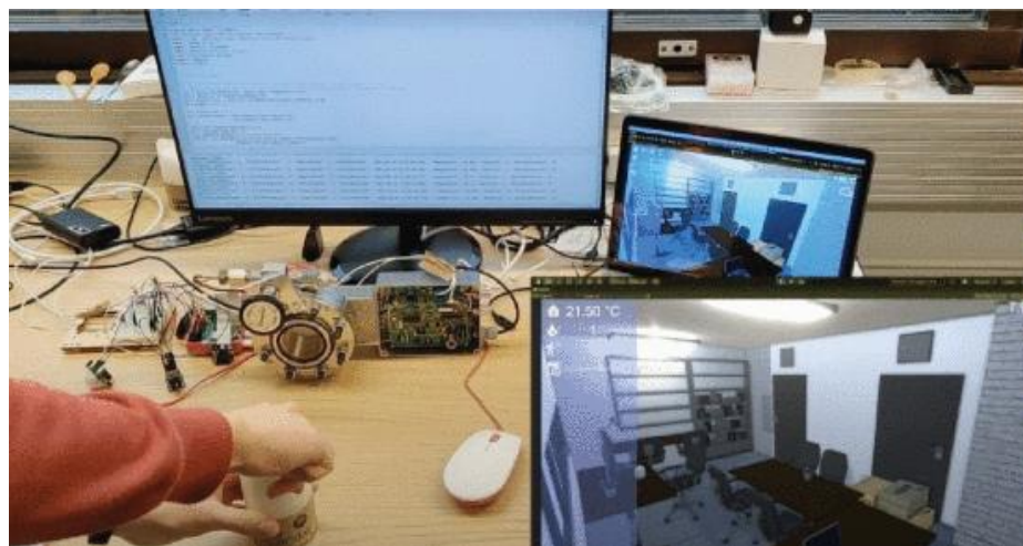
Figura 2 – “O fogo do tamanho de uma vela é detectado e instantaneamente exibido no modelo de visualização 3D do gêmeo digital” (Khajavi et al. , 2023, p. 52347, tradução nossa).
