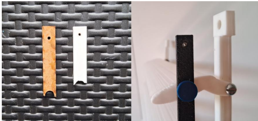
Figura 15 – A esquerda peças produzidas em MDF e PLA, a direita em APEX Carbono.
