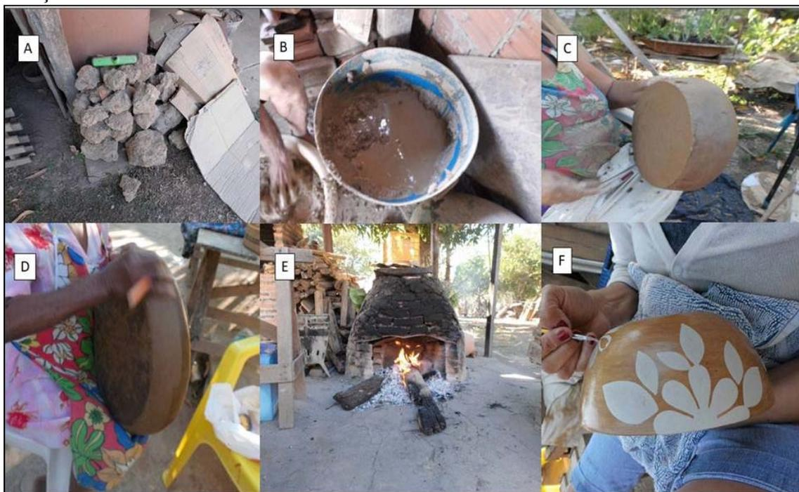
**Legenda:** **A** – Armazenagem do barro em torrão; **B** – Quebra e processo de derretimento de barro; **C** – Modelagem inicial do barro *in natura*; **D** – Refinamento do processo de modelagem; **E** – Cozimento do barro em forno a lenha artesanal e; **F** – Pintura e acabamento final nas peças de cerâmica. **Fonte:** Ingrid Regina da Silva Santos, 2017.
