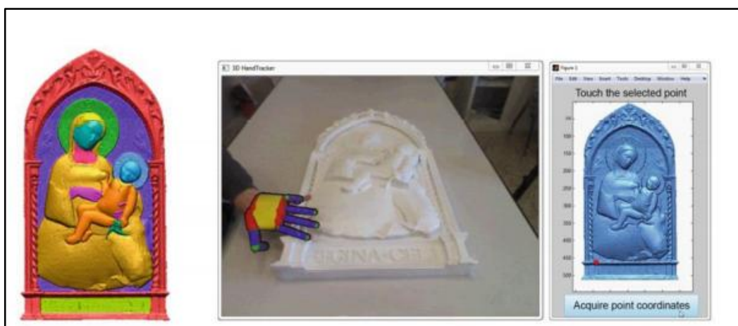
Figura 26 - Sistema de visão computacional para reconhecer a mão do usuário
