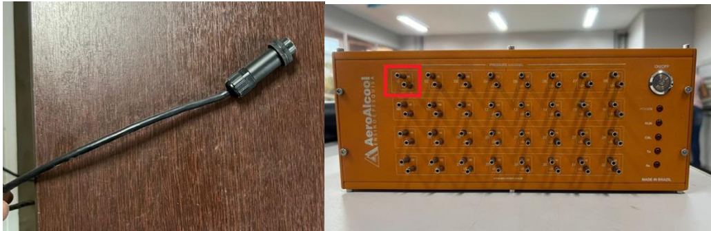
Figura 9.3: Cabo de dados e local de acoplamento dos tubos de pressão
