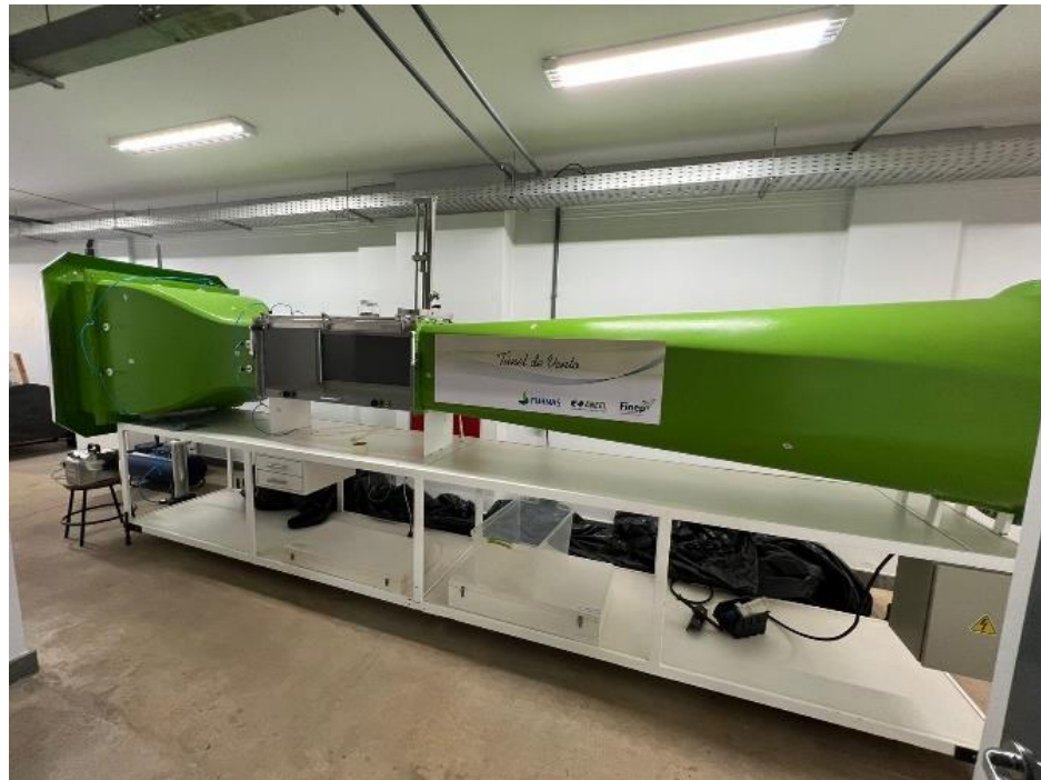
Figura 2.1: Túnel de vento de circuito aberto emprestado por Eletrobrás/Furnas
