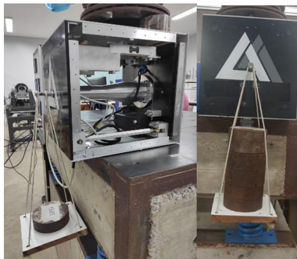
Figura 3.21: Balança aerodinâmica posicionada na mesa inercial com o suporte para as massas
