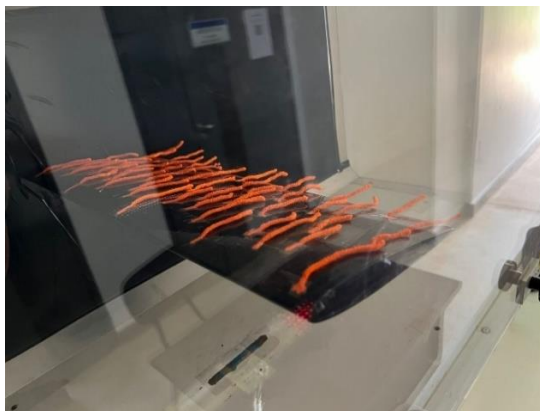
Figura 4.36: Aerofólio NACA0012, submetido a um escoamento com Re = 133438 , com fios de lã com ângulo de ataque de 7^\circ
