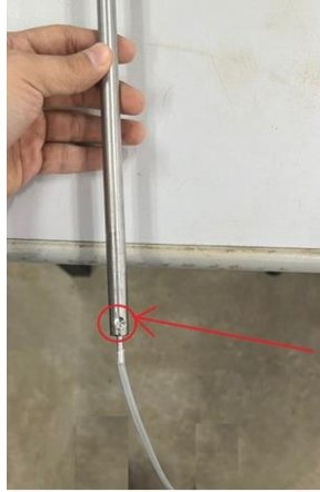
Figura 3.14: Barra de suporte do cilindro com a saída da tomada de pressão e chanfro de referência
