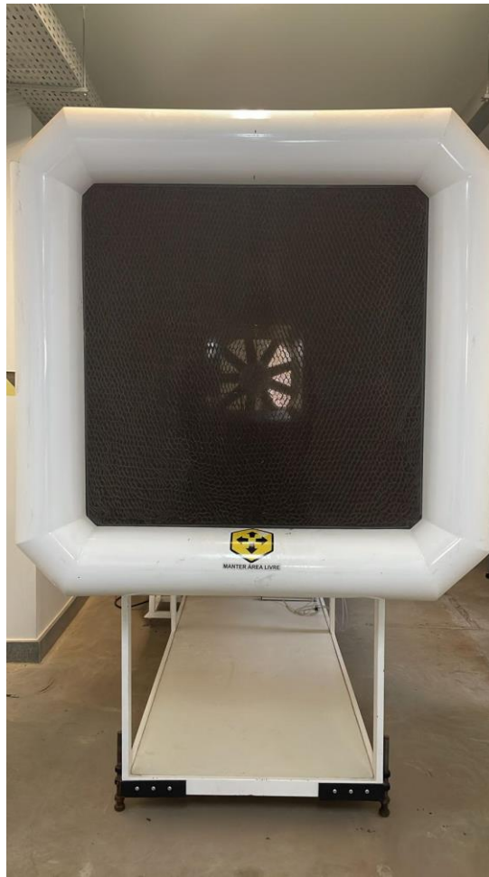
Figura 2.9: Colmeia do túnel de vento dentro da câmara de estabilização
