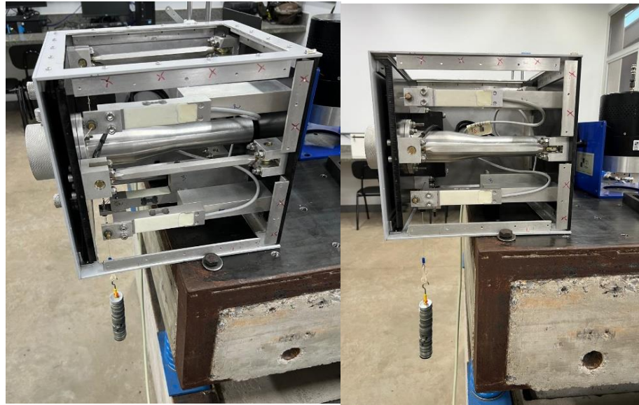
Figura 3.23: Calibração da componente do arrasto da balança
