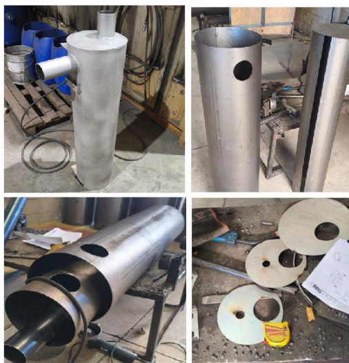
Figura 4.33: SRSO_{(GE)} conjunto, montagem e componentes.
