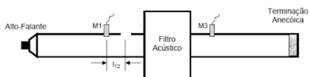
Figura 2.16: Esquema aparato experimental método das duas cargas.
