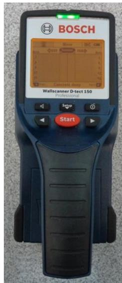
Para que a leitura das profundidades seja realizada, é necessário que a superfície seja plana, sem desníveis na área a ser escaneada. Não são informadas restrições para o aparelho pelo fabricante.
