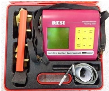
Esse ensaio foi realizado em cada elemento estrutural em que era possível ter acesso e todos os resultados são referentes à face interna do elemento estrutural. Devido às dificuldades de acessibilidade às faces internas do elemento estrutural, esses pontos amostrais estavam localizados em regiões próximas entre si. Nos locais onde seria medida a resistividade, enxarcava-se o concreto antes do início do ensaio.
