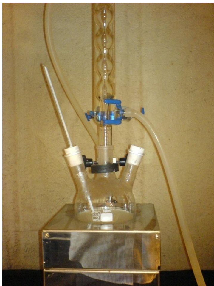
Figura 4-1 - Sistema de refluxo utilizado para a realização da síntese de hidrólise forçada.
