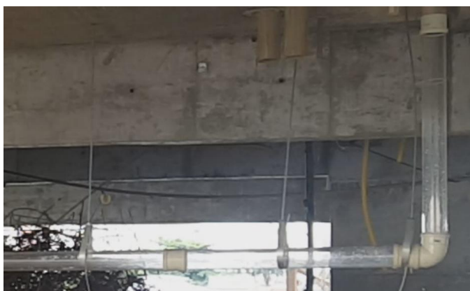
Figura 3.9- Instalação de joelho de 90°. J90-L.
