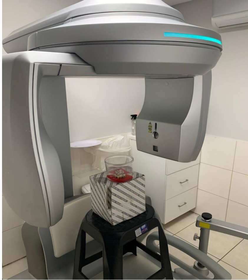
Figura 1 – Dentes incluídos em bloco de cera utilidade imerso em recipiente com água para realização do exame de TCFC em tomógrafo PreXion 3D Elite 13 bits (Fonte: autor)
