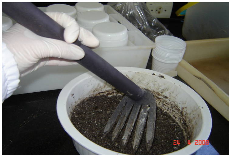
Figura 4.4.1 Processo da mistura manual do lodo de esgoto com a cal, realizada no teste preliminar para a definição das concentrações de cal a serem utilizadas.
