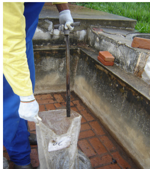
Figura 4.4.7 Amostragem de uma alíquota de lodo de um dos tratamentos
