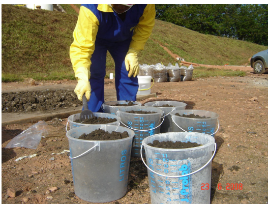
Figura 4.4.2 Preparo do lodo para calagem (quebra dos torrões)
