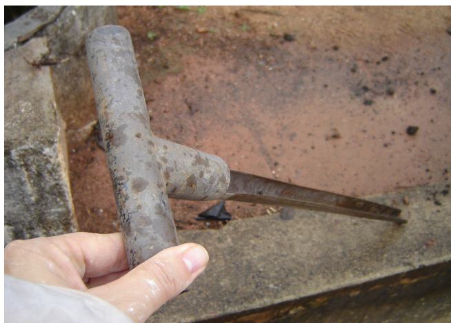
Figura 4.4.6 Amostrador do tipo “Trier” utilizado nas coletas de amostras
