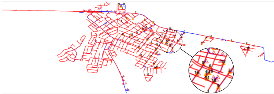
Figura 6.6 - Mapeamento da transgressão de tensão no Alimentador 7 da subestação Campinas.
