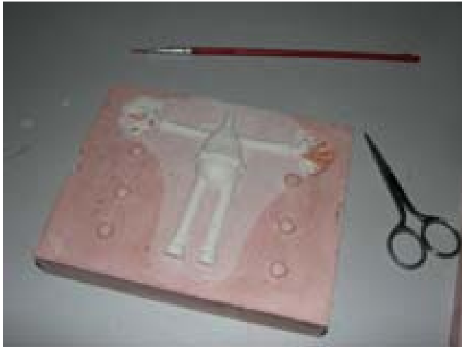
Figura - 45. Boneco de silicone sendo retirado do molde
