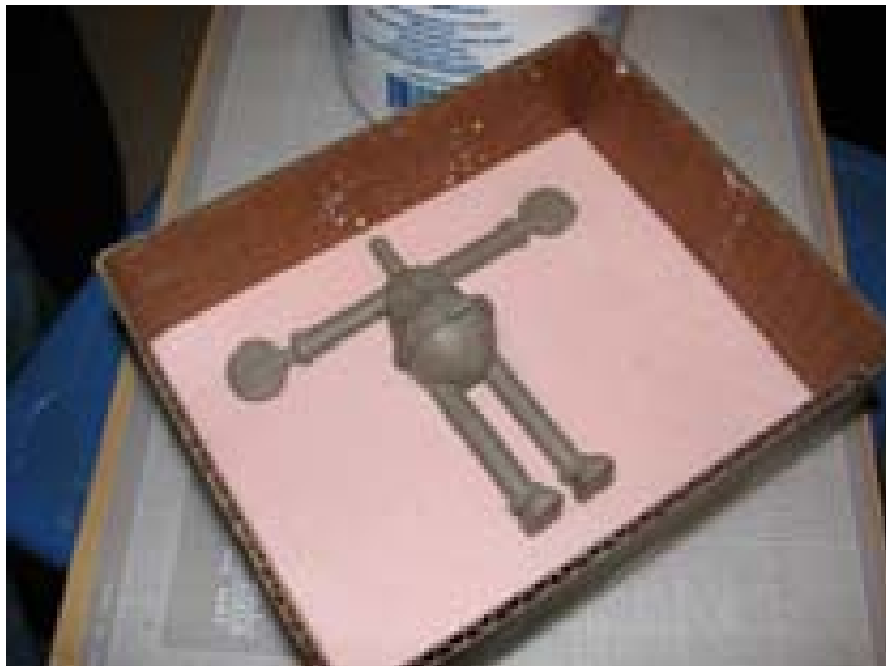
Figura - 43. Produção do molde em gesso
