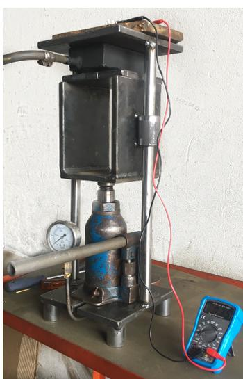
Figura 5.26 - Dispositivo para análise de contato e pressão.
