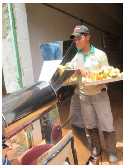
Etapa de despolpamento
