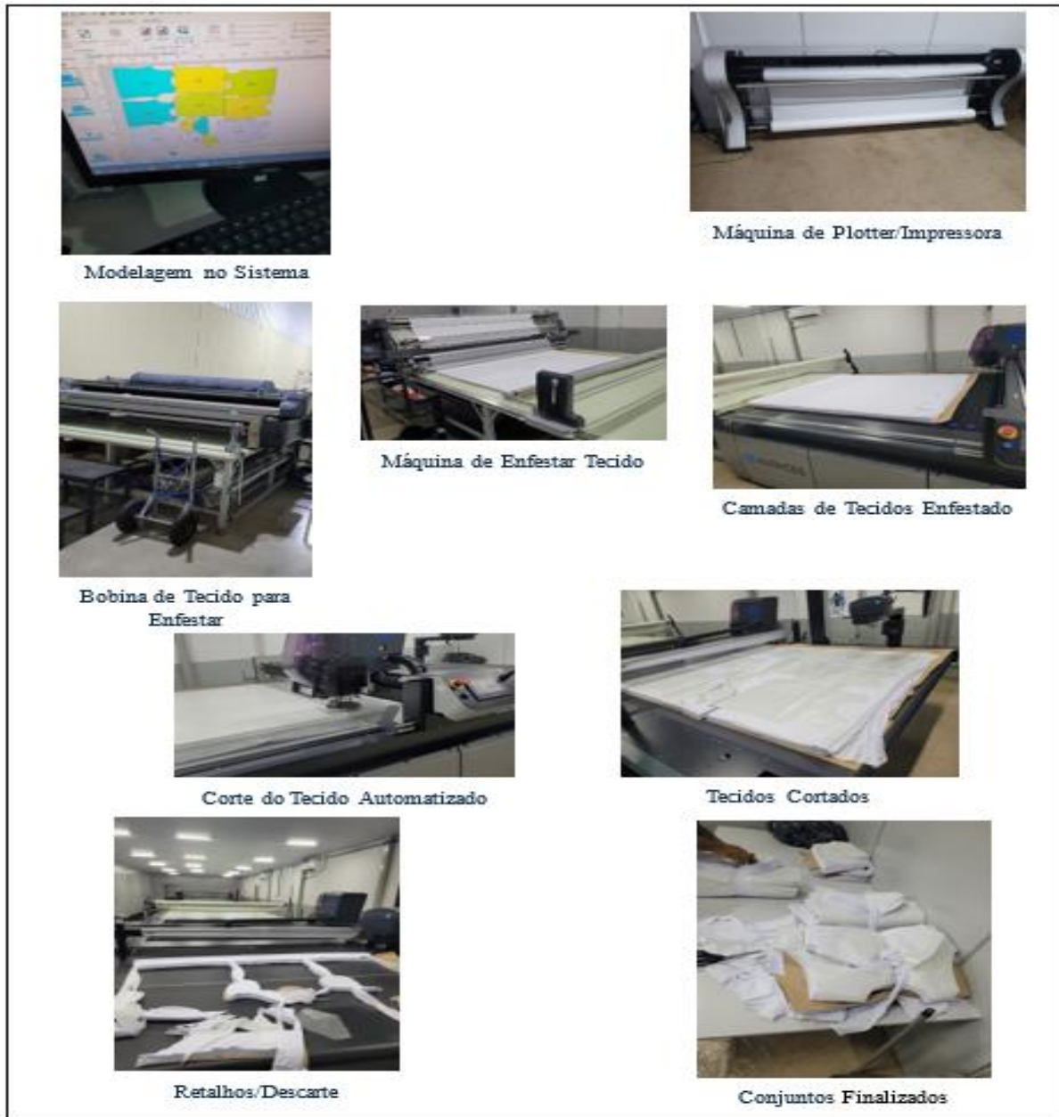
Figura 2 - Fotografias das etapas da máquina Audaces
