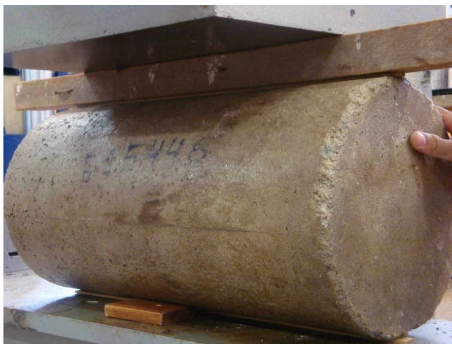
Figura 3. 8 – Preparação do corpo de prova de CCR de 300 mm de diâmetro para ser ensaiado à tração por compressão diametral
