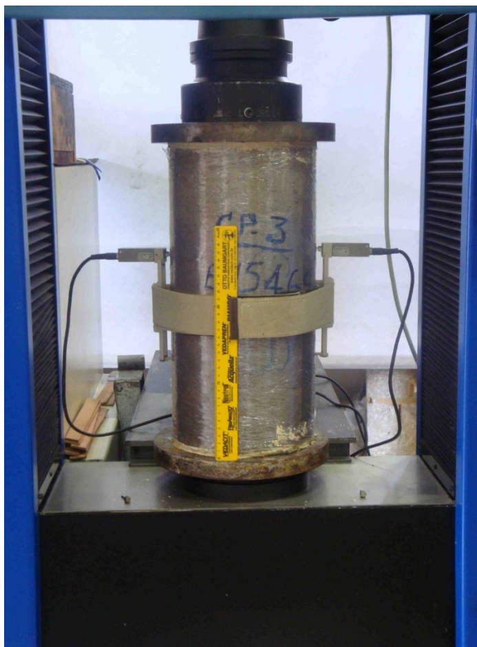
Figura 3. 12 – Corpo de prova de CCR de 200 mm de diâmetro instrumentado
