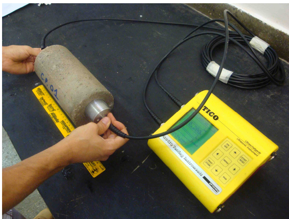
Figura 3. 10 – Execução do ensaio de ultra-som em corpo de prova de CCR de 100 mm de diâmetro
