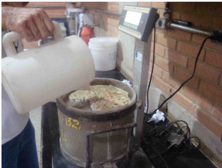
Figura 3. 3 – Preenchimento do cilindro de acrílico, mais CCR adensado, com água
