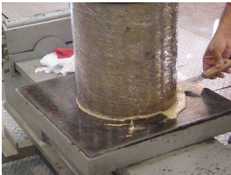
Figura 3. 7 – Retirada do excesso de gesso pedra durante o procedimento de capeamento do corpo de prova de 300 mm de diâmetro
