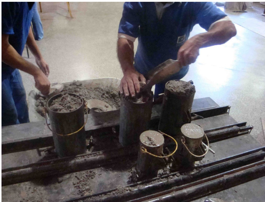
Figura 3. 4 – Lançamento do CCR em moldes de diferentes tamanhos
