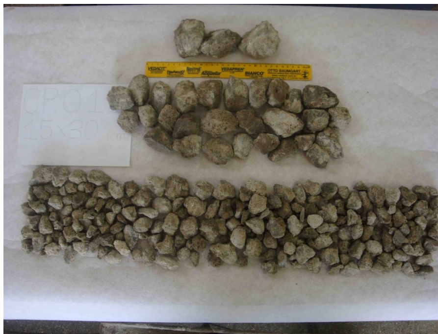
Figura 3. 16 – Quantidade de agregados graúdos extraídos de um dos corpos de prova de 150 mm de diâmetro
