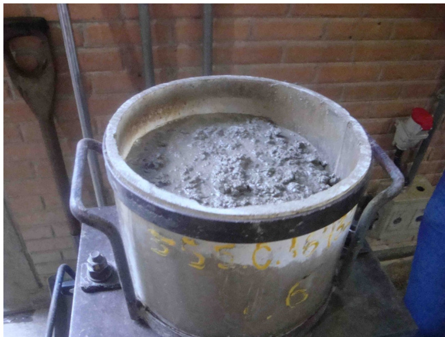
Figura 3. 2 – CCR adensado após a realização do ensaio Vebe
