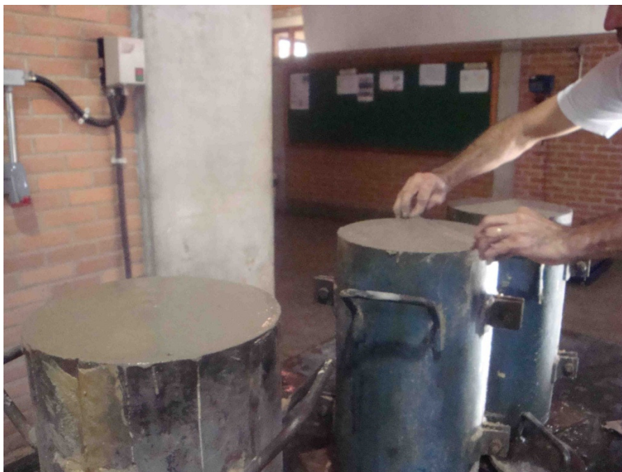
Figura 3. 5 – Acabamento do topo do corpo de prova com régua metálica de 30 cm de comprimento
