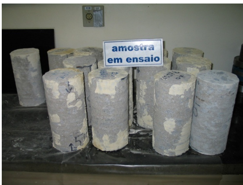
Figura 3. 9 – Corpos de prova preparados para serem ensaiados à compressão triaxial
