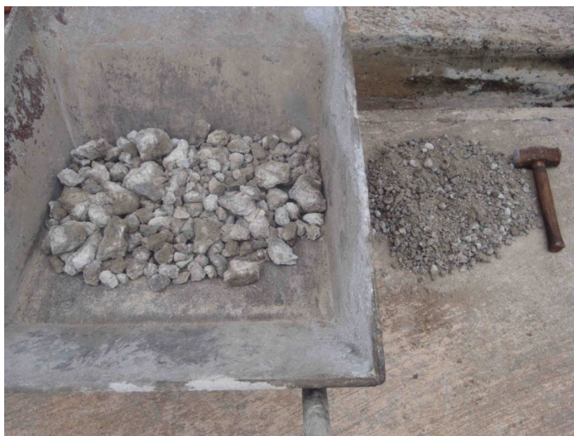
Figura 3. 15 – Agregados graúdos no carrinho-de-mão e argamassa no chão ao lado da marreta
