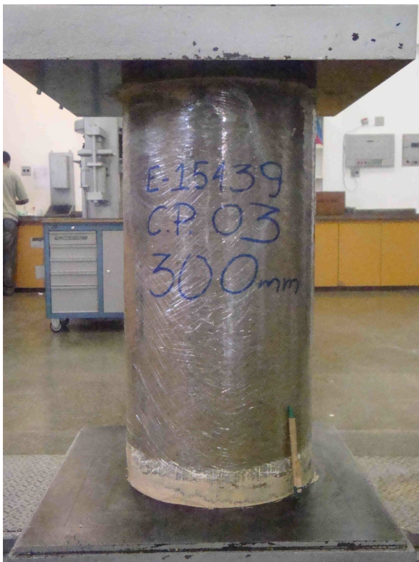
Figura 3. 11 – Ensaio de Compressão Simples em um corpo de prova de CCR de 300 mm de diâmetro
