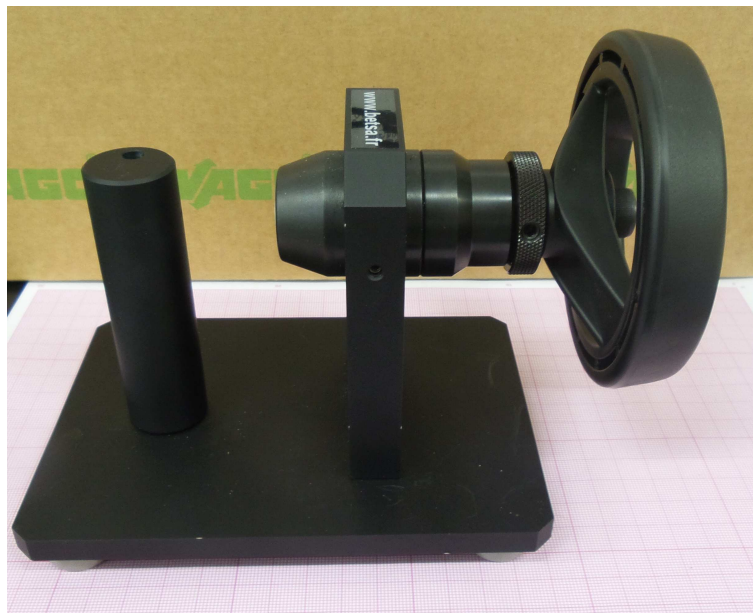
Figura 4.8: Crimping tool - Equipamento para fixação do fio de tungstênio ao capilar
