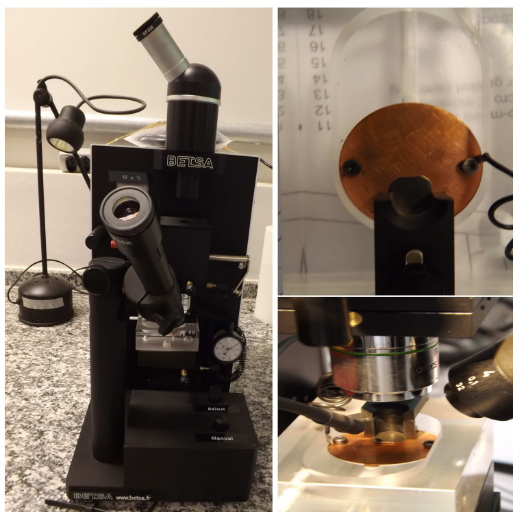
Figura 4.6: Máquina de eletroerosão Betsa MH20 utilizada na fabricação da junta metálica
