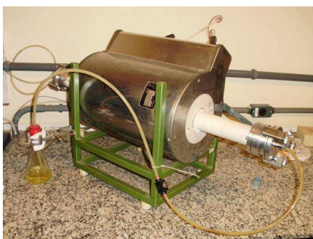
Figura 3.5 – Sistema de flujo montado sobre horno para quema pirolítica a 700 °C en atmósfera de nitrógeno.
