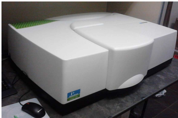
Figura 2.13 - Espectrofotómetro de UV/Vis/ NIR, marca PerkinElmer, modelo Lambda 1050 WB usada para obtener los espectros de reflectancia difusa.
