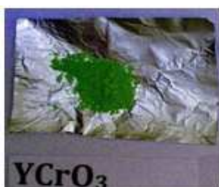
Figura 3.6 – Polvo de YCrO 3 color verde esmeralda claro obtenido después de la calcinación a 1300°C.
