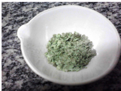
Figura 3.9 – Cromita de itrio \text{YCrO}_3 obtenida después de la combustión en la forma de hojuelas de color verde claro e oscuro.
