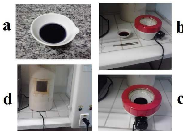
Figura 3.8 – Procedimiento en el m todo de combust n (a) soluci n acuosa de los nitratos de itrio y cromo en agua ultra pura en c psula de porcelana, (b) e (c), soluci n en c psula de porcelana y manta t rmica de calentamiento y (d) dispositivo de protecci n para evacuaci n de los gases producido en el proceso de combust n y evitar dispersi n del material.
