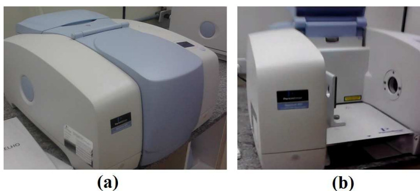
Figura 2.11 - (a) Equipo espectrofotómetro Perkin Elmer modelo Spectrum 400 usado para obtener las medidas de absorbancia (b) detalle del soporte de la muestra y el trayecto del haz en el equipo.
