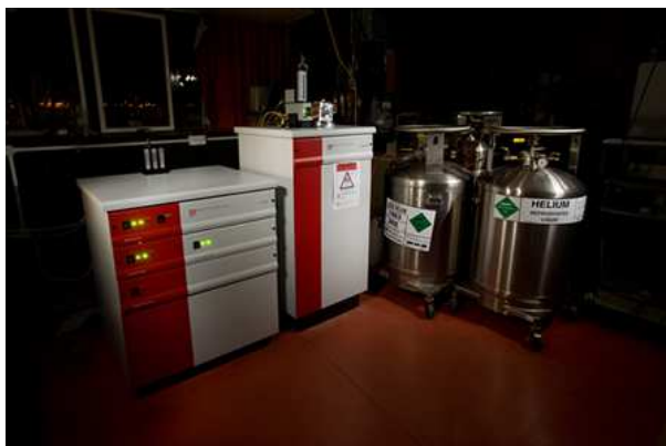
Figura 2.15 - Magnetómetro SQUID típico.
