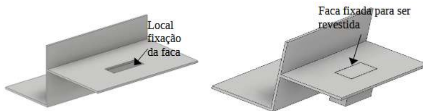
Figura 3.13: Projeto do suporte para fixação das facas
