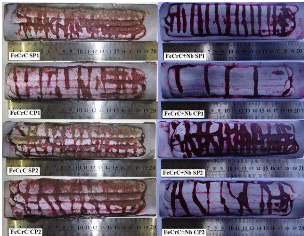
Figura 2.38: Resultado com líquido penetrante nas trincas com revestimento de 1 e 2 camadas com FeCrC ou FeCrC + Nb
