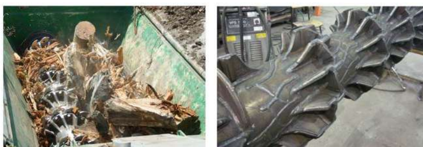
Figura 2.5: Eixo sem fim do moedor recuperado pelo processo de soldagem
