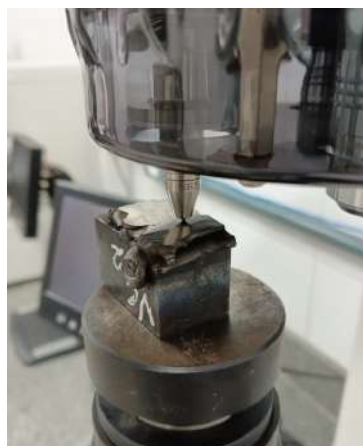
Figura 3.10: Ensaio de dureza das camadas de soldas
