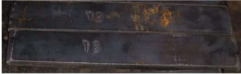
Figura 3.3: Chapa base para os testes de parametrização da solda
