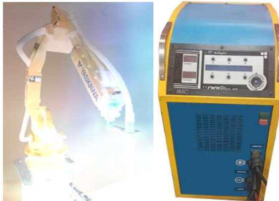
Figura 3.4: Manipulador robótico Yaskawa Motoman HP20 e fonte IMC DIGIPlus A7
