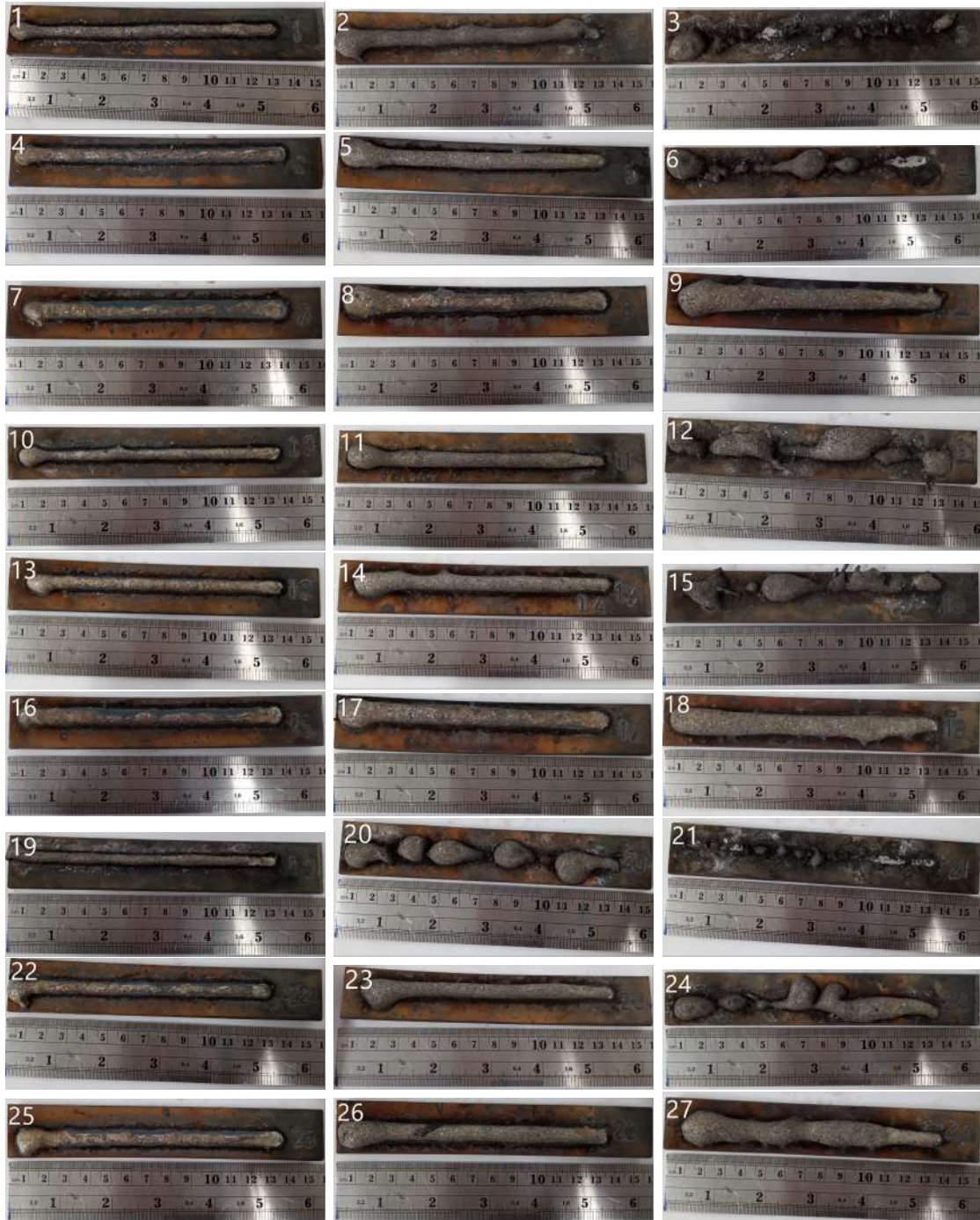
Figura A.1: Teste da soldagem realizado nas chapas de aço para parametrização da solda.
