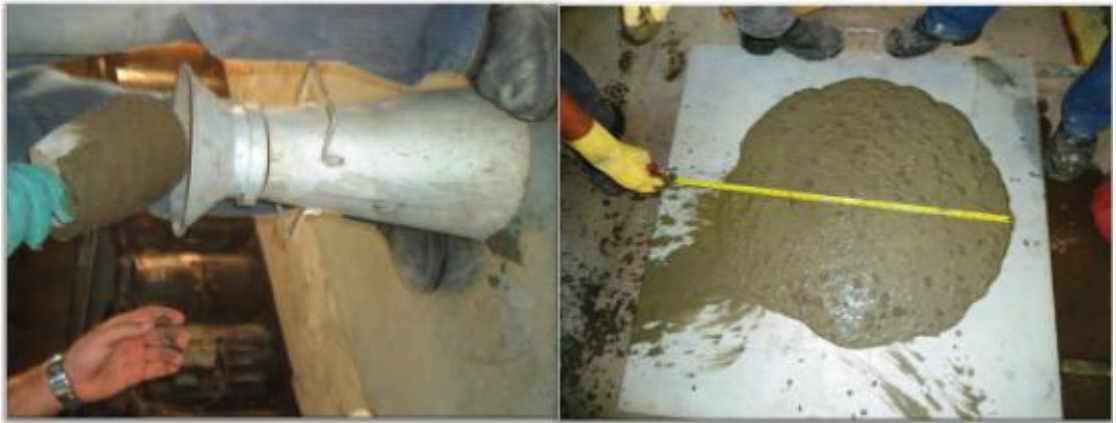
Figura 45 – Ensaio do Cone de Abrams
