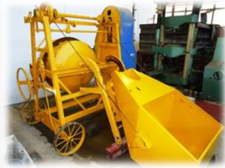
b) Betoneira utilizada
