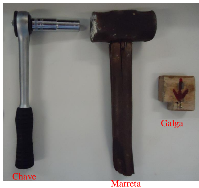
Figura 56 – Ferramentas utilizadas para fixação dos chumbadores
