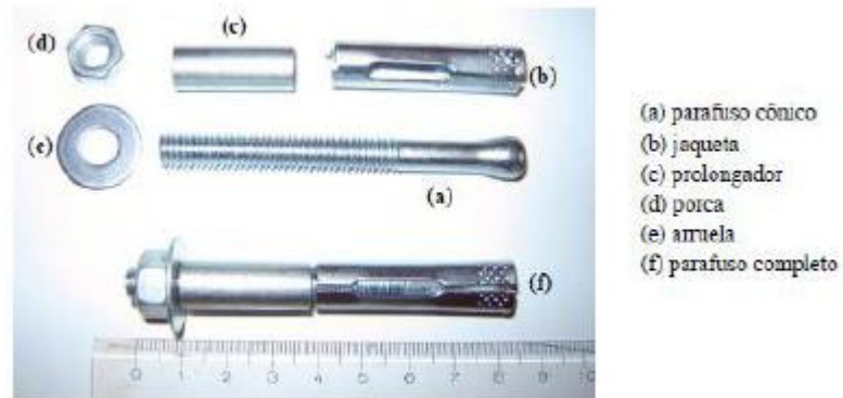
Figura 14 – Chumbadores de expansão tipo AF (SAHB, 2008)
