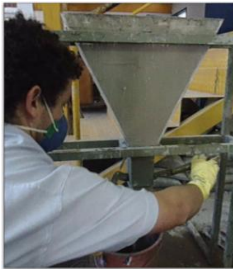
Figura 46 – Ensaio do Funil V
