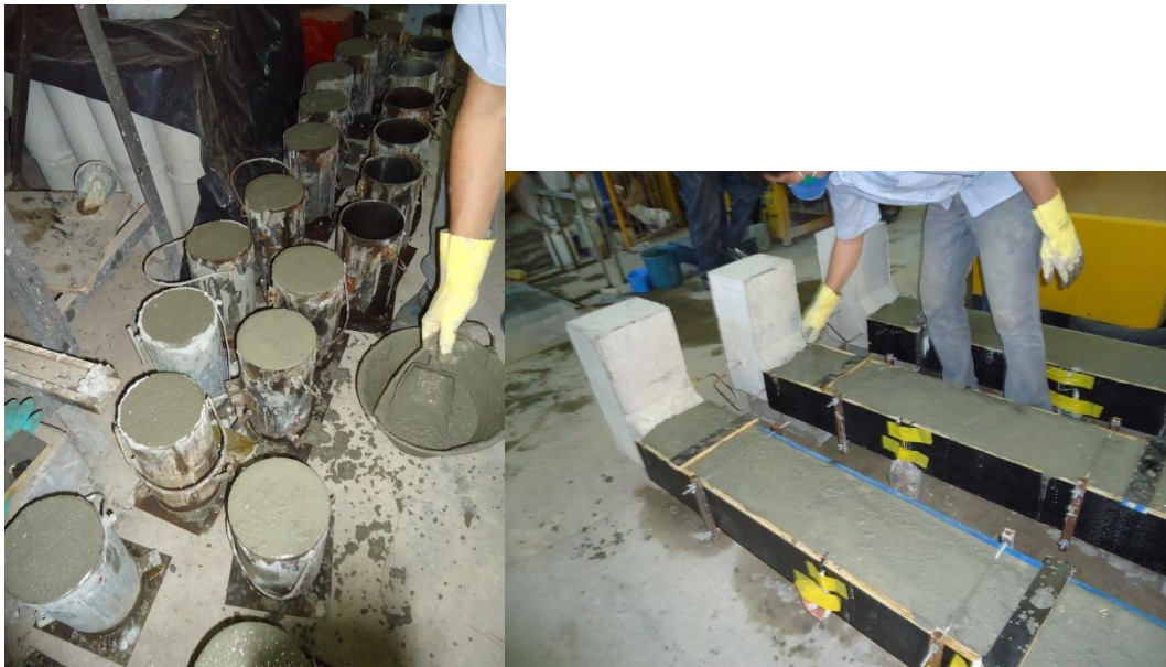
Figura 60 – Moldagem dos corpos de prova e acabamento final do concreto
