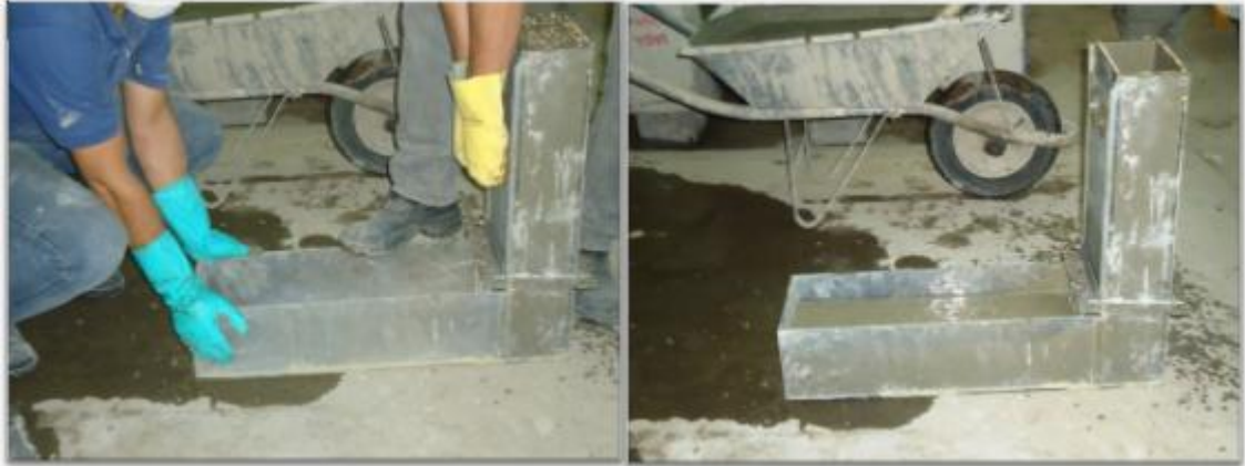
Figura 44 – Ensaio da caixa L
