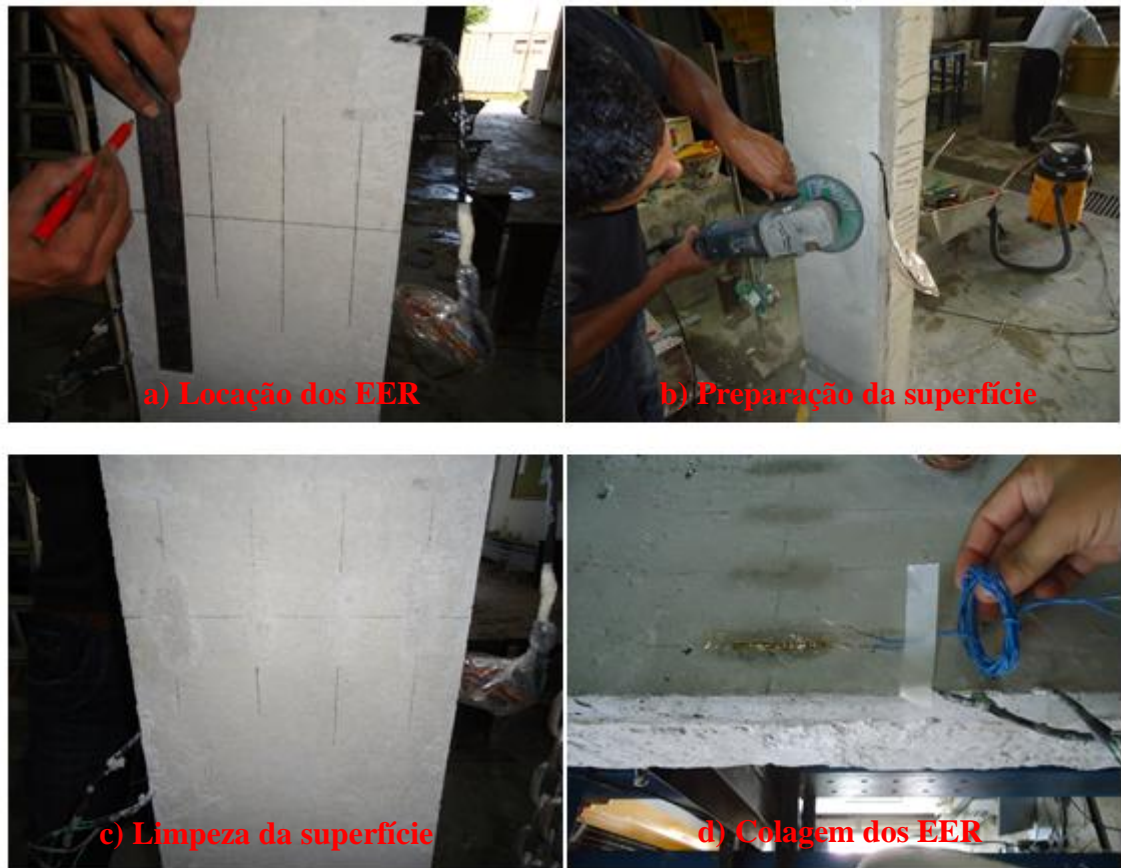
Figura 63 – Colagem de extensômetros no concreto
