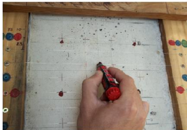
Figura 52 - Marcação da posição dos chumbadores
