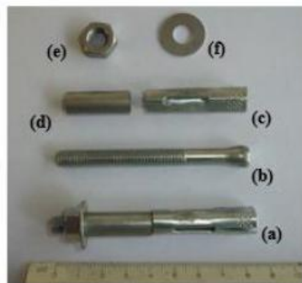
Figura 20 - Detalhe do chumbador tipo AF 5/16'' x 80 mm (VIRGENS, 2015)
