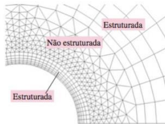
Figura 12 – Exemplo de Malha Híbrida (Çengel e Cimbala, 2015)
