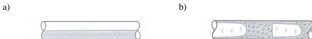
Figura 3 – Padrão de escoamento encontrado no interior de microcanais: (a) estratificado; (b) não-estratificado (Adaptado de Alves, 2015).
