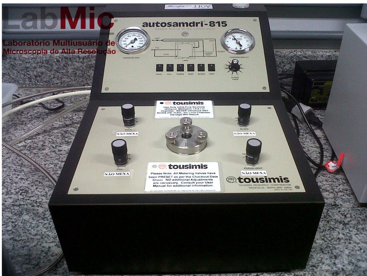
Figura 7 - Sistema de secagem de amostras pelo ponto crítico de CO<sub>2</sub>, Autosamdri®, 815, Series A, com um porta amostra de 4 cavidades cilíndricas.
