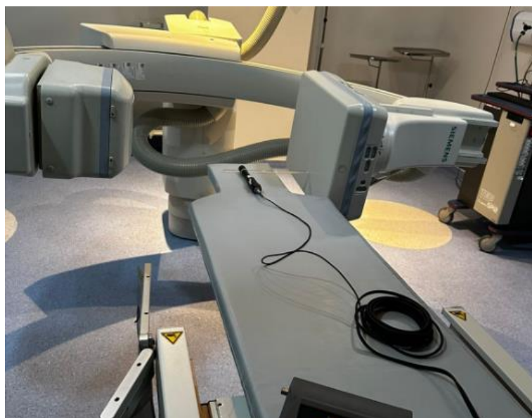
Figura 20- Configuração para medição do kerma no ar de referência (Fonte: O autor).
