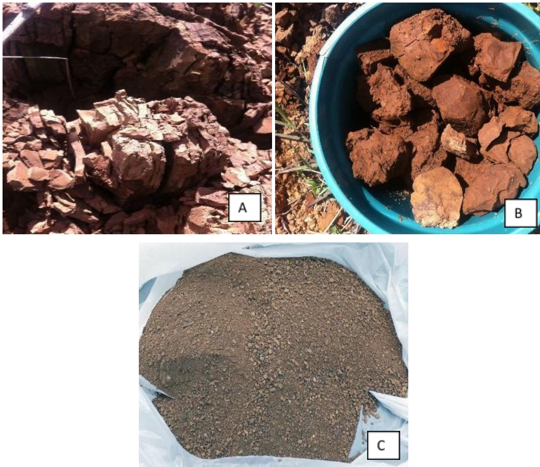
Figura 4. RETA em lagoa de secagem (a), após a coleta (b) e após a trituração (c).
